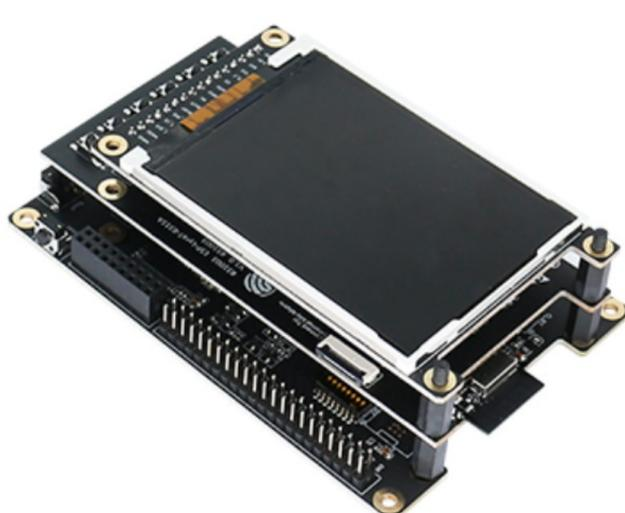
A nova placa de desenvolvimento multimídia, ESP32-S2-Kaluga-1, é baseada no ESP32-S2 e possui várias funções, como tela de toque de LCD, controle por painel de toque, aquisição de imagem da câmera, reprodução de áudio, etc. Pode ser flexível montado e desmontado, cumprindo assim uma variedade de requisitos personalizados.
